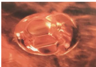
热处理红宝石中部分熔融的单斜磁黄铁矿
