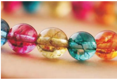
图 4-7 染色水晶裂隙处可见颜色浓集
