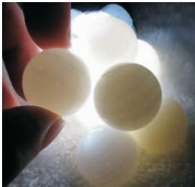
图 6-24 透光观察，可见砗磲贝的层状结构
