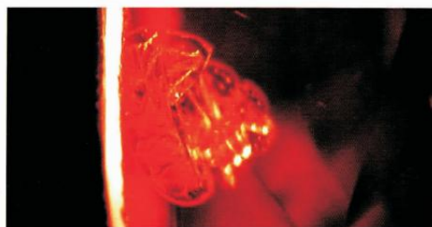
图 3-23 Be 扩散蓝宝石内包体产生的局部重结晶
