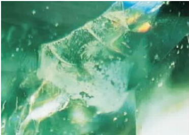
图 3-30 裂隙中的充填物及闪光效应
