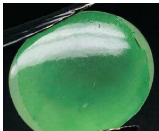
图 5-18 覆膜翡翠可见薄膜脱落现象
