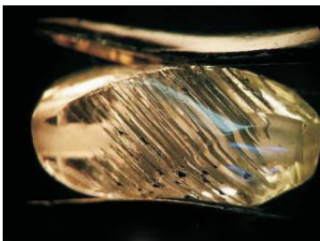
图 4-4 合成水晶仿发晶中的钉管状包体 (一头大一头小，管内有染料充填)
