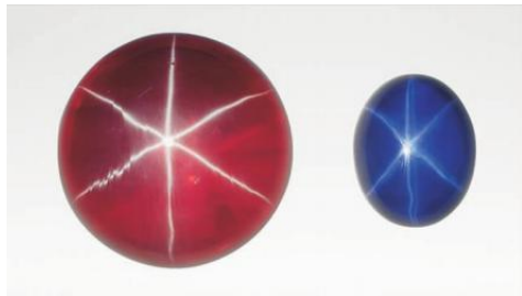
图 3-1 焰熔法合成星光红、蓝宝石
