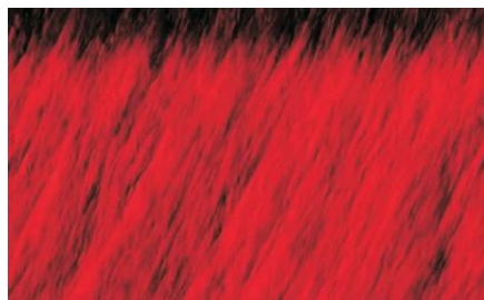
图 3-9 水热法合成红宝石中的波纹状生长纹
