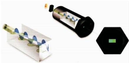
图 2-16 冰洲石二色镜原理示意图
