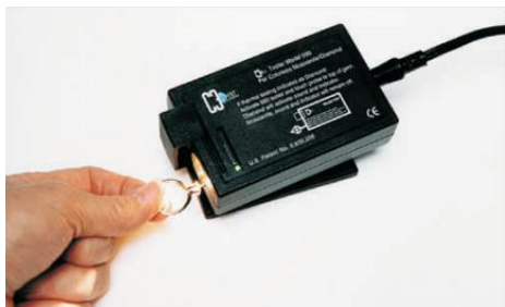
图 2-35 590型无色合成碳硅石/钻石测试仪
