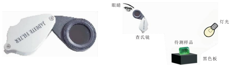
图 2-30 查氏镜外观及使用方法示意图
