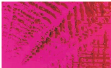
图 3-7 定向排列的浅黄色助熔剂残余
