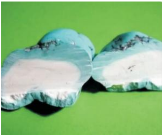
图 5-3 染色羟硅硼钙石颜色仅存在于浅表层和裂隙间
