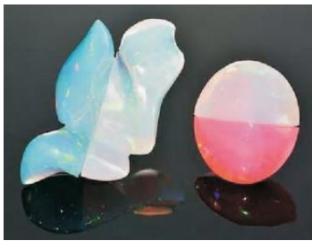
图 5-27 染色欧泊浸泡在 3%过氧化氢溶液后退色
