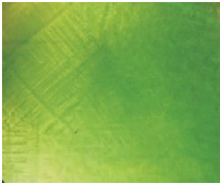
图 7-2 脱玻化玻璃中类似蕨叶状的结构
